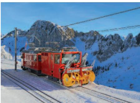
Die von einer Elektrischen Zweikraft-Zahnradlokomotive von Stadler gestoßene Zaugg-Schneeräumenanlage MVR-Naye Xrote 4 der Transports Montreux-Vevay-Riviera MVR. Die Zaugg AG Eggwil ist ein weltweit führendes Unternehmen in der Entwicklung und Herstellung technisch hochstehender Geräte für die Schneeräumung auf Straße, Schiene und Flugplätzen sowie spezialisierter Geräte für die Bearbeitung von Schneepisten. Seite 19
