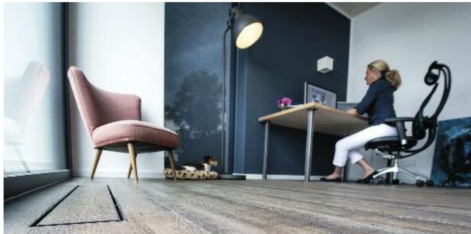
Die rechteckige Austrittsöffnung verteilt die Frischluft über einen nur zirka 5 Millimeter breiten, kaum sichtbaren Spalt.
