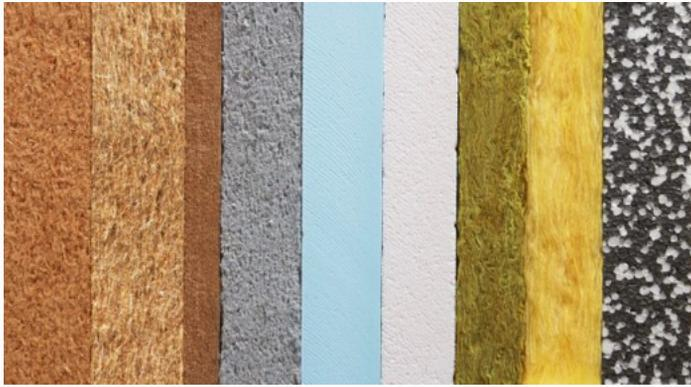
Dämmstoffe aus nachwachsenden Rohstoffen bieten auch nach einem Zeitraum von über zehn Jahren sowohl im Winter als auch im Sommer hervorragenden und dauerhaften Wärmeschutz. Eine Einschränkung der Gebrauchstauglichkeit kann auch über den langen Zeitraum hinweg nicht nachgewiesen werden. Dies ist das Ergebnis einer Untersuchung im Demonstrationszentrum Bau und Energie des Handwerkskammer Bildungszentrums
