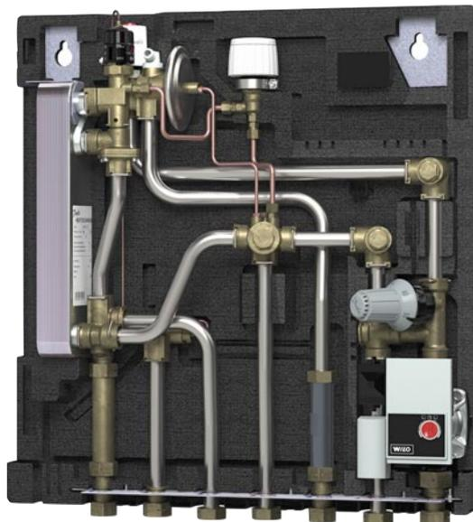
*Blick auf eine Danfoss Evo-Flat MSS Wohnungsstation: Ganz links der Micro-Plate-Wärmeüberträger, daneben (mit schwarzer Kappe) der TPC-M-Multifunktionsregler.*
