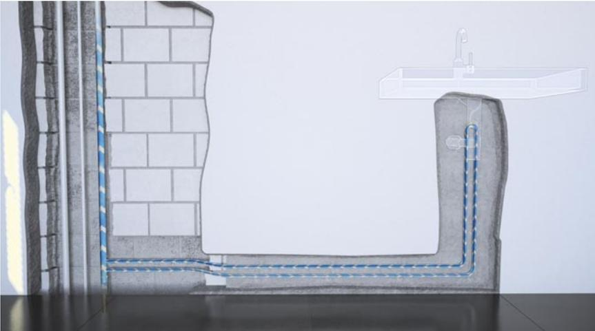
Ringinstallation mit Strömungsteiler
