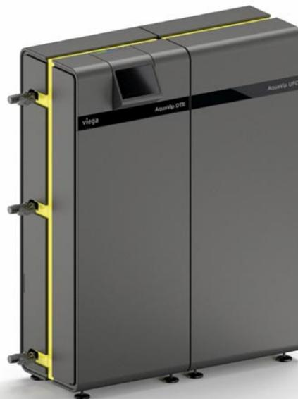
Schon bei der Warmwasserbereitung setzt Aqua-Vip Solutions mit einem neuartigen Durchfluss-Trinkwassererwärmer (DTE) an. Er kann mit einem Ultrafiltrationsmodul (UFC) für einen Teilvolumenstrom der Zirkulation Trinkwasser warm gekoppelt werden, um die Bakterien und Nährstoffe im Rohrleitungsnetz zu reduzieren.
