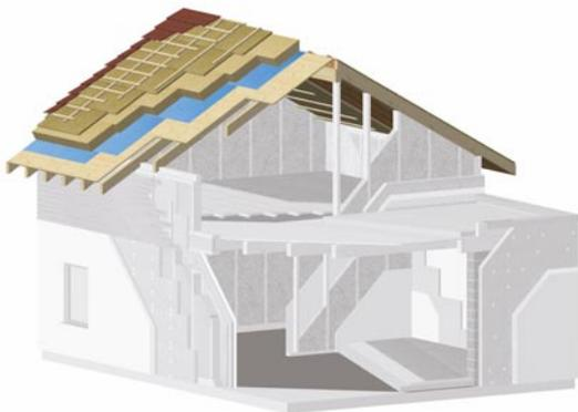
*Das Dachsanierungssystem ergänzt das Dach um eine regensichere Unterdeckplatte, eine feuchteregulierende Gefachdämmung sowie eine Luftdichtungsbahn.*
