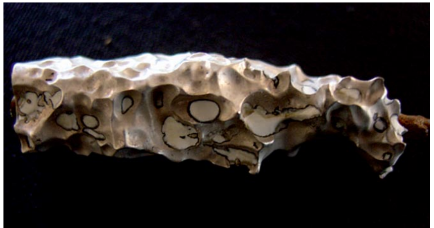
Eine zur Hälfte verbrauchte Schutzanode.
